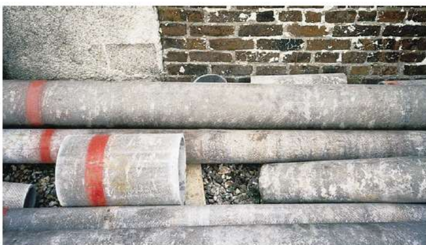
Débris amiante ciment
